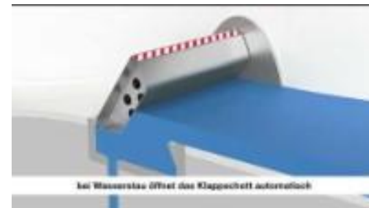
Klappschott (Animation) Quelle: Aeschlimann Hochwasserschutz AG
